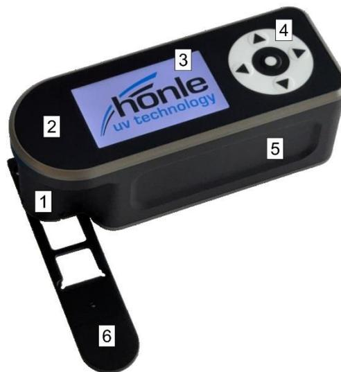
1. 光学タワー：下面の開口部から紫外線が放出されます（項目7を参照）。
